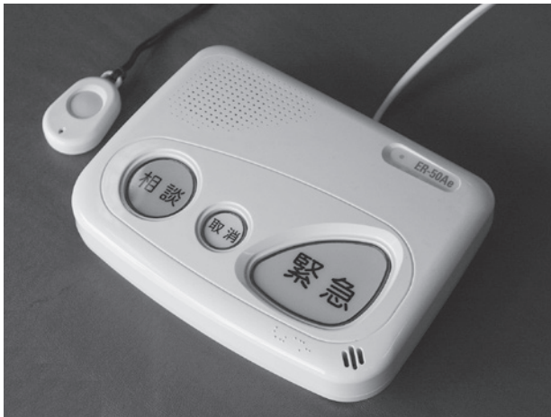
緊急通報装置
